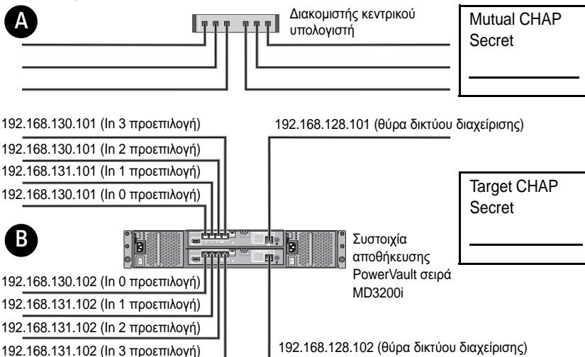
Αν χρειάζεστε πρόσθετο χώρο για περισσότερους από έναν διακομιστής κεντρικού υπολογιστή, χρησιμοποιήστε πρόσθετο φύλλο.
