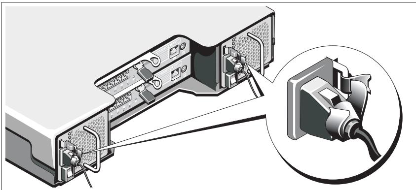
Ασφαλίστε τα καλώδια τροφοδοσίας σταθερά στο στήριγμα χρησιμοποιώντας την παρεχόμενη ταινία.
