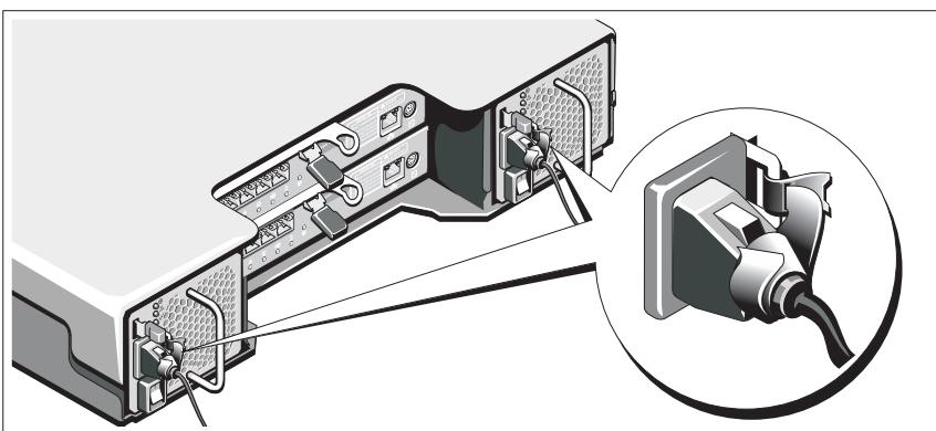
Fixez fermement les câbles au support de fixation à l'aide de la lanière fournie. Branchez ensuite l'autre extrémité des câbles d'alimentation sur une prise de courant mise à la masse ou sur une source d'alimentation autonome (onduleur [UPS] ou unité de distribution de l'alimentation [PDU]...). Chaque bloc d'alimentation doit être connecté à un circuit d'alimentation différent.
