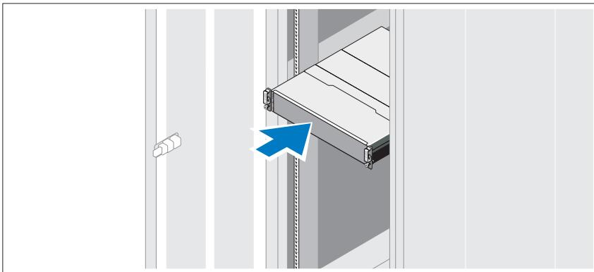
Ensamble los rieles e instale el sistema en el bastidor siguiendo las instrucciones de seguridad y de instalación del bastidor incluidas con el sistema.
