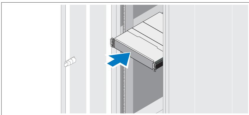
Смонтируйте направляющие кронштейны и установите систему в стойку согласно прилагаемым инструкциям по технике безопасности и инструкциям по установке стойки.
