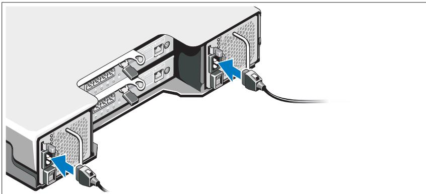
Upewnij się, że przycisk zasilania znajduje się w położeniu wyłączonym przed przystąpieniem do podłączania kabli zasilania. Podłącz kable zasilania do systemu.
